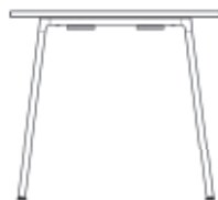
A-Fuß: Fixe Höhe, 72 cm A-leg: Fixed height, 72 cm
