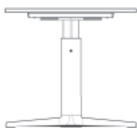
T-Fuß: Variable Höhe, Schraube, 62-92 cm T-leg: Variable height, screw, 62-92 cm
